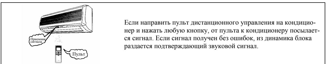
Если направить пульт дистанционного управления на кондиционер и нажать любую кнопку, от пульта к кондиционеру посыпается сигнал. Если сигнал получен без ошибок, из динамика блока раздается подтверждающий звуковой сигнал.
